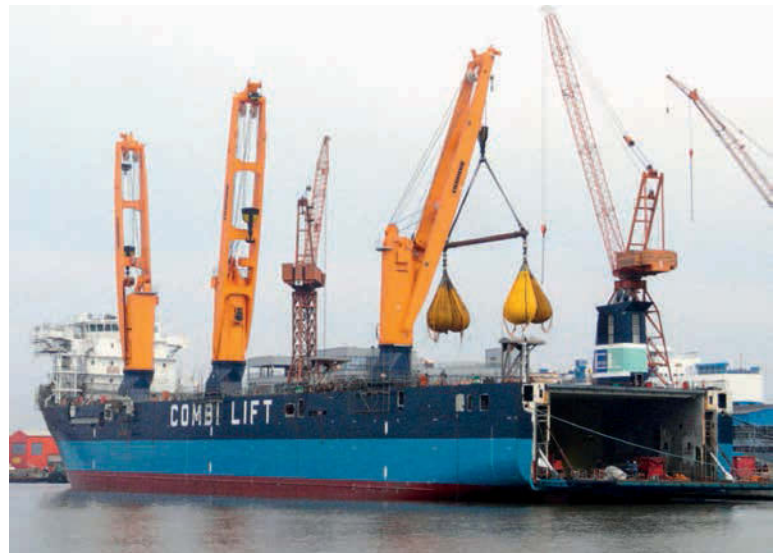
Das 162,3 m lange und 25,4 m breite Spezialschiff „Combi Dock“ soll für den Transport rollender und schwimmender Ladung eingesetzt werden
