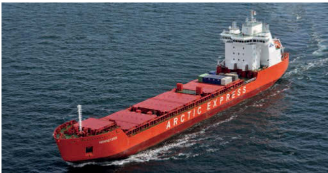
Das eisbrechende Containerschiff „Monchegorsk“ von Aker Yards verfügt über eine Stellkapazität von 646 TEU
