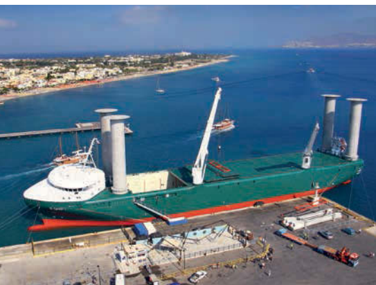
Das Spezialschiff „E-Ship 1“ verfügt über vier Segel-Rotoren und wird 2010 in Dienst gestellt
