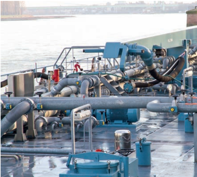
Rohrleitungen aus Edelstahl Rostfrei sorgen auf Tankschiffen für die nötige Sicherheit Foto: WZV / AdobeStock Jürgen Fälchle
