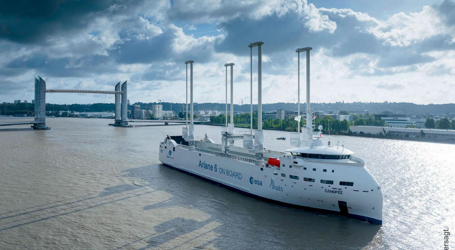
Die 121 m lange „Canopée“ ist mit vier elektrisch verstell- und einklappbaren Gelenkflügeln ausgestattet, die als Segel fungieren Foto: ESA
