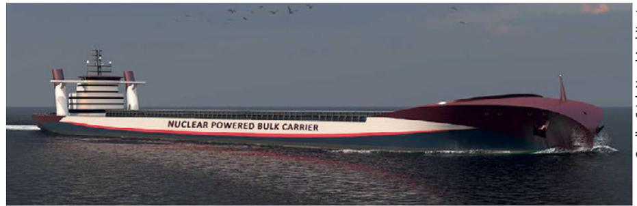
Konzept eines nuklearbetriebenen Massengutfrachters von ULC-Energy und C-Job Naval Architects
