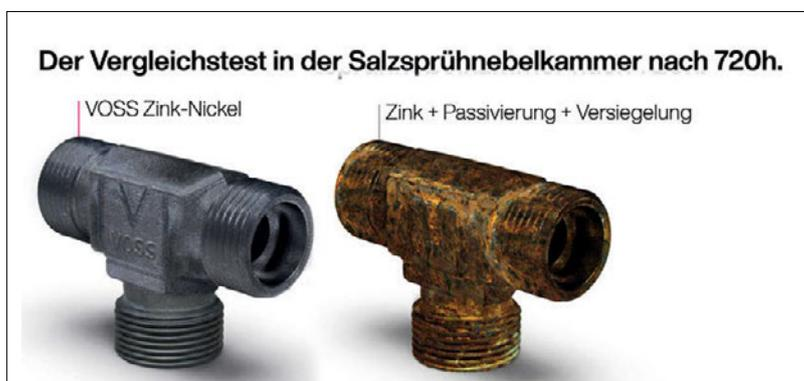
Abb. 2: Vergleich Salzsprühnebeltest Voss coat vs. Zink-Beschichtung
