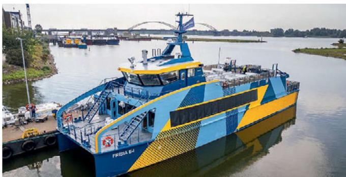
Der neue Elektrokatamaran ist mit zwei Aluminiumrümpfen ausgestattet, die einen Tiefgang von 1,2 m ermöglichen Foto: Media Creators
