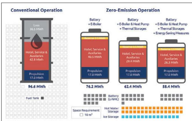
Abb. 8: Gesamtenergiebedarf für den konventionellen Betrieb gegenüber der benötigten Batteriekapazität für das Zero-Emission-Szenario bei unterschiedlicher technischer Umsetzung und zusätzlicher Energiesparmaßnahmen, inklusive abschätzender Vergleich der volumetrischen Energiedichte
