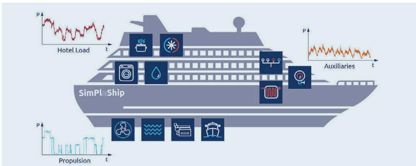
Abb. 1: Hauptbereiche des Energiebedarfs auf Kreuzfahrtschiffen: Antrieb, Hilfsaggregate, Hotellast
