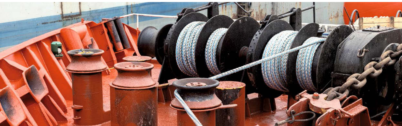
Die Snap-Back-Arrestor-Leinen von Timm Ropes sollen die Gefahr eines Snap-Backs verringern
