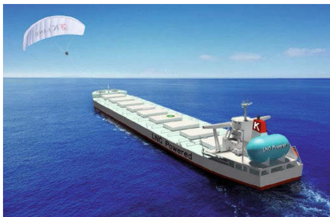
Die Drachensegelsysteme von Airseas sollen eine Emissionsreduzierung von 20 Prozent ermöglichen
