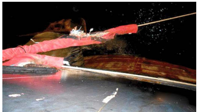
Gerissene Seile mit intaktem SBA
