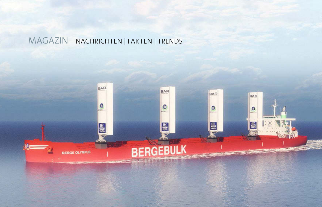
Die BAR Tech WindWings sollen den Treibstoffverbrauch reduzieren
