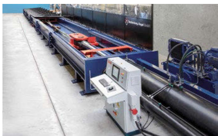
Blick entlang der Zugprüfmaschine mit Steuerpult Foto: Tecklenborg Kegel GmbH
